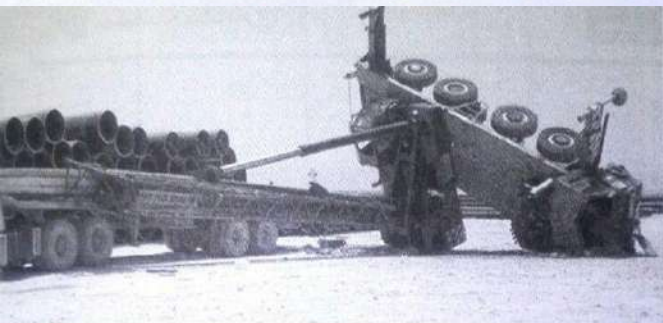
شکل ۲۶.۴ خطر واژگونی و شکست ساختاری با توجه به تغییر شعاع
